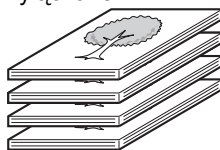
Przesunięcie offsetowe wyłączone
